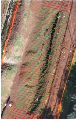
Figura 4.15: Esempio di corretta classificazione di scavo aperto
