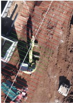
Figura 4.17: Errata classificazione causata dalla presenza di un mezzo pesante
