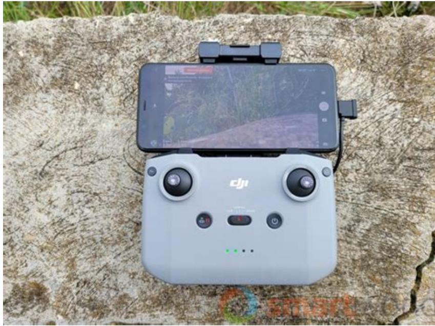
Figura 1.3: Dispositivo di comando del drone DJI MINI 2 con un dispositivo mobile come periferica
